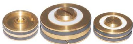
**Материал уплотнения:** PTFE (тефлон, фторопласт-4) – латунный поршень с фторопластовым уплотнением седла и графитовыми кольцами скольжения.
